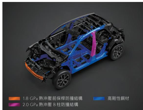
1.8 GPa 熱沖壓前保桿防撞結構      高剛性鋼材
